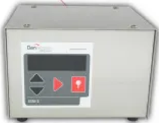
Газоанализатор Dansensor ISM-3i O2 Вес: 3,7 кг Время реакции: 10 мин
